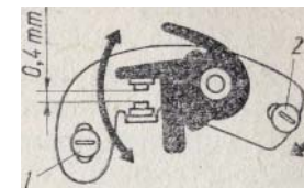
Joonis 2.27. Katkesti kontaktide reguleerimine; 1 kinnituskrugi, 2 ekstsentrisk
